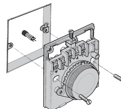
Přímé připevnění na stěnu
