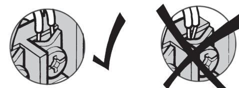
Kabely od topného či chladicího zařízení připojte k termostatu podle obrázku vlevo. Podrobnosti najdete v popisu u schéma zapojení.
